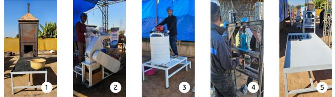
Nach Überprüfung der Funktionsfähigkeit habe ich die Handwerker\*innen zur **Serienfertigung und Wartung** der Maschinen geschult; technische Zeichnungen und Schablonen unterstützen den Nachbau der Prototypen.
